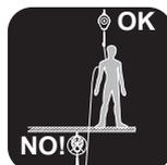
Fator de queda 0. O ponto de fixação deve ficar situado acima do utilizador e possuir uma resistência mínima de 15 kN.
